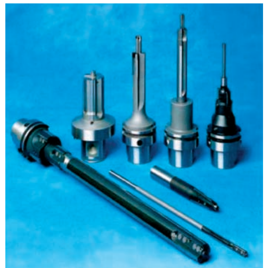
Рисунок 2. Вид разверток изготавливаемых компанией Seco Tools AB по спецзаказу
