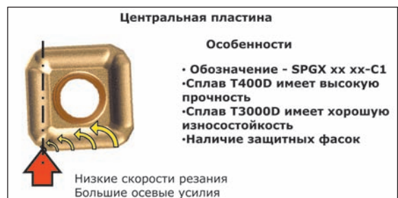
Рисунок 3. Особенности конструкции центральной пластины
