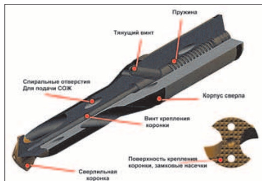
Рисунок 1. Конструкция сверл CrownLoc производства SECO TOOLS
