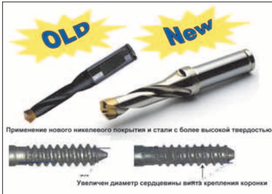
Рисунок 5. Совершенствование конструкции сверл CrownLoc
