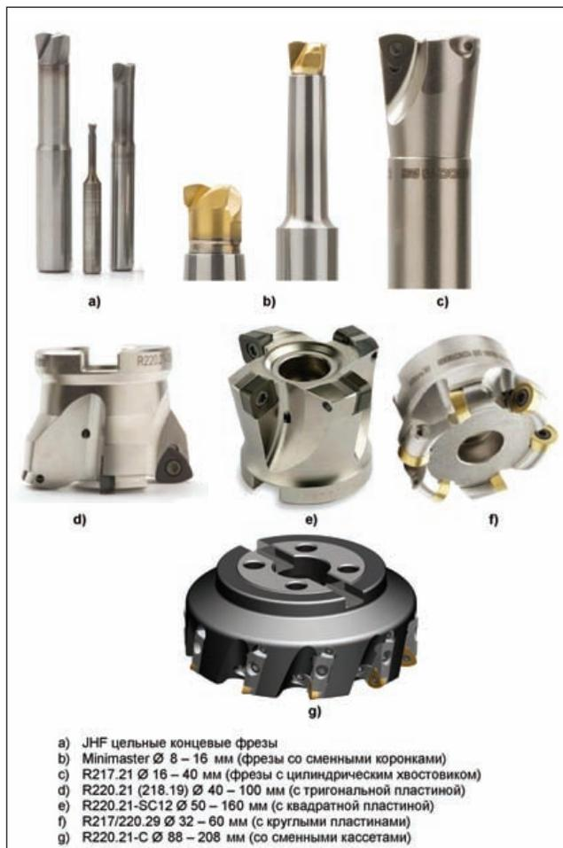
Рисунок 2. Конструкция High Feed фрез производства SECOTOOLS
