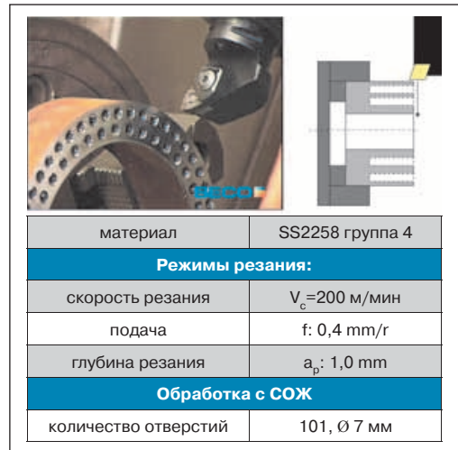
Рисунок 7. Тест на ударную прочность
